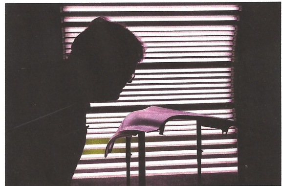
Simulationsresultat (ZebraLinien) zur Kontrolle der Oberflächengüte (li.) und Kontrolle der Oberflächengüte am abgepressten Bauteil (re.).
