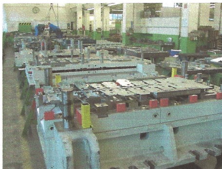
Dicht an dicht entstehen bei der Werkzeugbau Laichingen GmbH unter anderem hochwertige Folgeverbundwerkzeuge.
