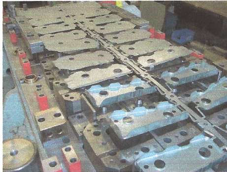
Unterteil des Folgeverbundwerkzeugs mit Blechstreifen und unterschiedlichen Umformgraden.
