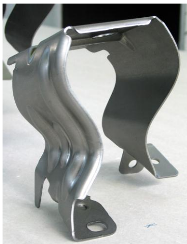
Die Freiformflächen für die Kniefängerstütze ließen sich mit VISI-Series problemlos konstruieren.
