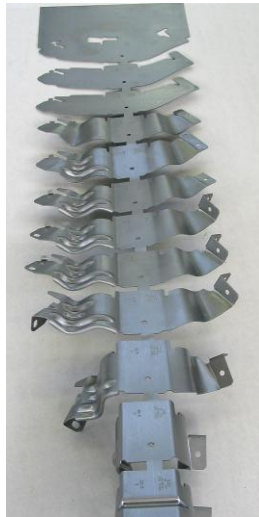
Nach Fertigstellung des Werkzeugs werden die ersten Probestreifen gefertigt.
