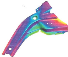
Darstellung der Verschiebung in Normalenrichtung, d.h. der Abweichung zwischen Bauteilgeometrie und Sollgeometrie.
