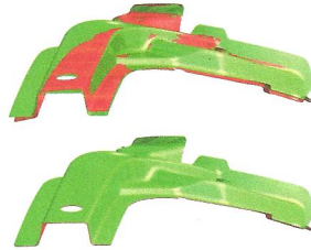
Bauteilgeometrie (rot) und Sollgeometrie (grün) vor (oben) und nach der Rückfederungskompensation.
