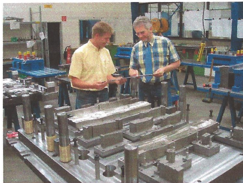
Eberhard Budde und Burkhard Gerling des GWB begutachten die ersten Abmessungen des Bauteils vor dem Oberteil des Formstanzwerkzeugs.
