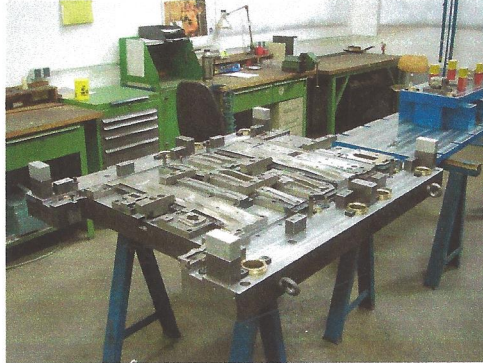
Unterteil des Formstanzwerkzeugs für eine Dachverstärkung.
