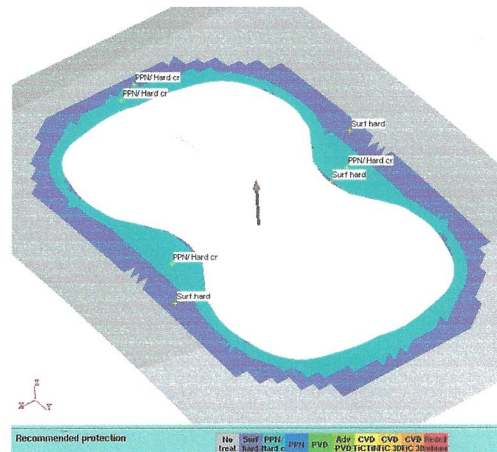
AutoForm DieAdviser zeigt den erforderlichen Verschleißschutz am Blechhalter an.
