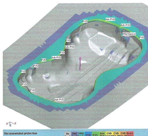
Erforderlicher Verschleißschutz an der Matrice nach einer Verschleißanalyse mit AutoForm-DieAdviser. Im Bereich Matrizeneinlaufradius ist mindestens eine „Advanced PVD“-Beschichtung auf Stahlbelag erforderlich.
