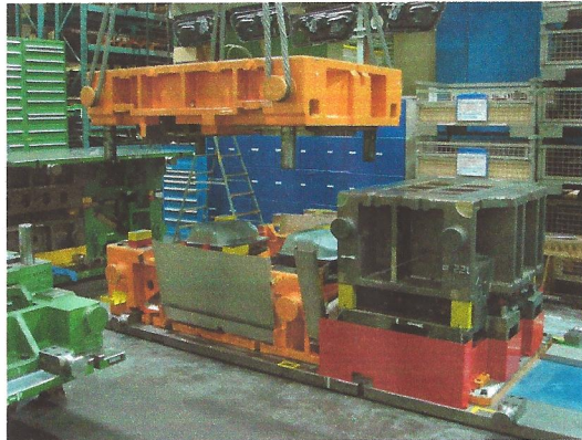
Das Werkzeug des Blechteils eines Geländewagens ist bereit für den Einbau in die Produktionspresse.
