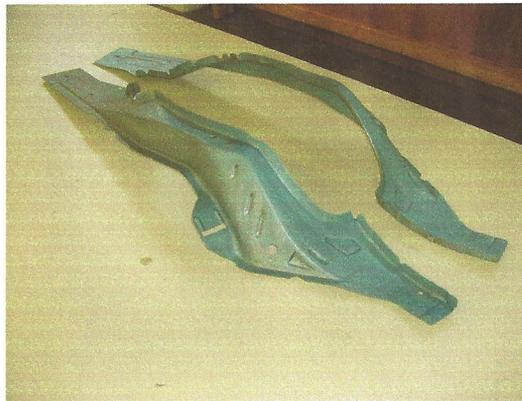
*Die beiden Längsträger wiesen geschwungene Formen in allen 3 Achsrichtungen auf und hochgestellte Flansche brachten zusätzliche Spannungen ins Bauteil.*
