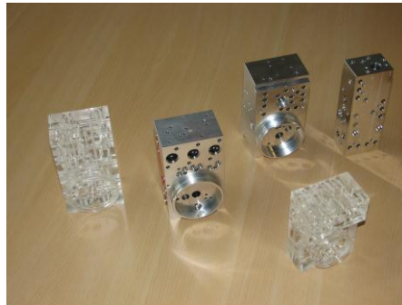
Verschiedene Steuerblöcke, teils aus Metall, teils aus Glasfaser, um die Vielzahl der Bohrungen zu demonstrieren.
