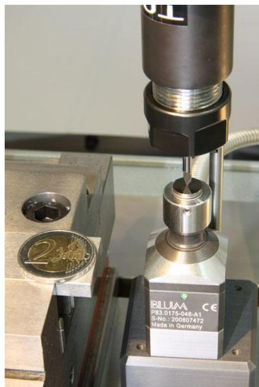
Aufgrund der integrierten Linearführung können mit dem Tastkopf Z-Pico selbst sensibelste Mikro-Werkzeuge schnell und zuverlässig überwacht werden.
