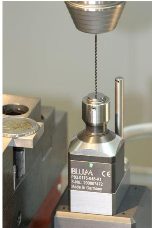
Der neue Tastkopf Z-Pico wird zur Werkzeuglängenmessung und Bruchkontrolle auf kleinen Bearbeitungszentren, z.B. in der Uhren- und Elektronikindustrie, eingesetzt. Sein verschleißfreies, optoelektronisches Messwerk garantiert konstant präzise Messergebnisse und höchste Zuverlässigkeit.
