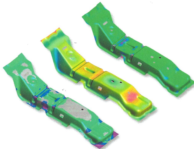
Die qualitative Beurteilung basiert meist auf der Machbarkeit, der Maßhaltigkeit und der Oberflächengüte (von links nach rechts).
