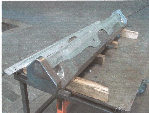
Der L-förmige Crashträger springt sowohl in Längsrichtung als auch in Schenkelrichtung auf.
