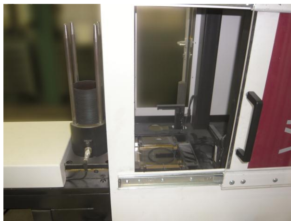
In Modul 1 wird die Vermessung der Wanddicke, des Außendurchmessers sowie aller Segmente an jedem U-Flex-Ring durchgeführt.
