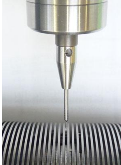
Der Messtaster kann mit Tasteinsätzen mit einem Kugel-Durchmesser von gerade einmal 0,5 mm bestückt werden.
