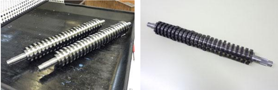
Die Zerkleinerungswalzen können durch Einsatz des Blum-Messtasters vollautomatisch auf dem Dreh-Fräszentrum gefertigt werden.
