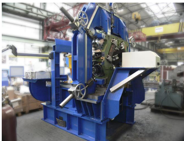
Das PSM ist der erste auf dem Markt erhältliche 3-Walzen-Präzisionswalzblock mit vier oder fünf Gerüstkassetten für Stäbe mit hydraulischer Anstellung; das VideoCAD-System ist für die Vermessung der Walzen ‚zuständig‘.
