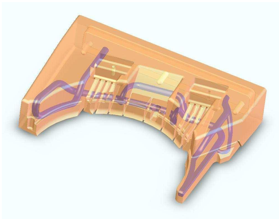
Füllsimulation mit konturnaher Kühlung in VISI 20.
