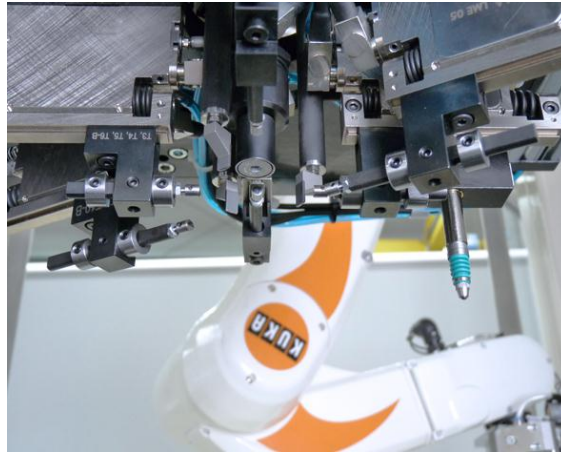
Der BMK 5 wurde bei ixetic mit einer Messeinrichtung für Vakuumpumpenrotoren ausgestattet.
