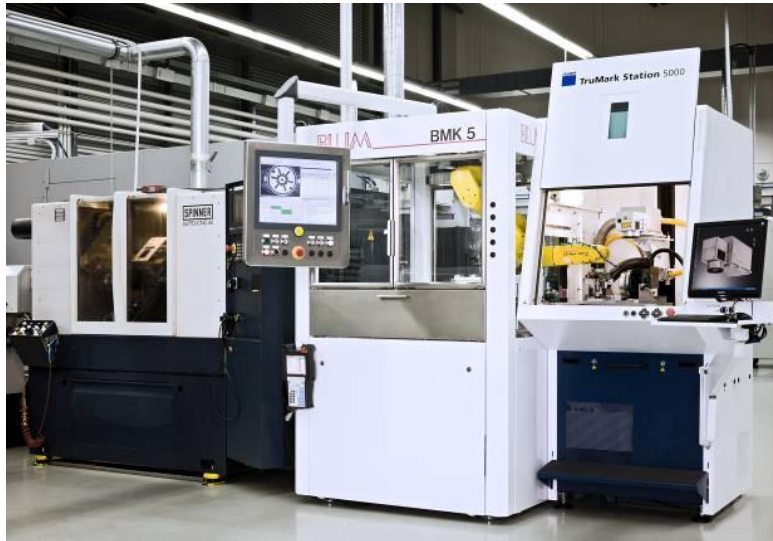
Auch Blum-Novotest setzt den BMK 5 in der eigenen Fertigung ein. Die Werkstücke werden nach der Bearbeitung automatisch gemessen und per Roboter in eine Laserbeschriftungsstation übergeben.
