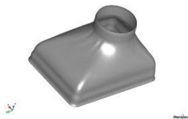
Das Bauteil im Stampack-System nach dem Ende der Simulation.
