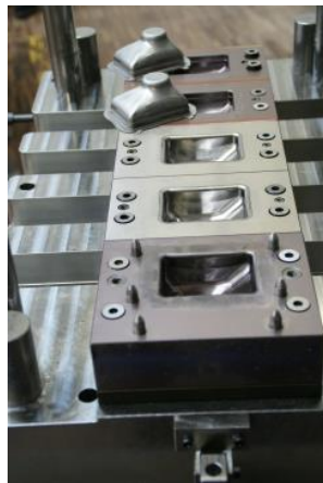
Das Unterteil des Ziehwerkzeugs mit dem Bauteil.
