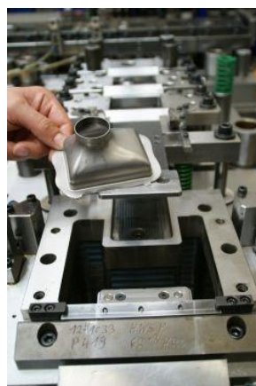
Der obere Teil des Verbundziehwerkzeugs mit dem Bauteil, noch unbeschritten.
