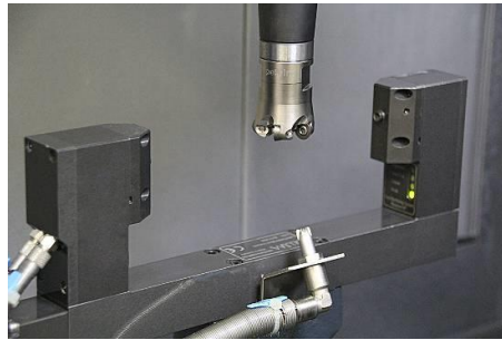
Im Formenbau des Playmobil-Herstellers geobra Brandstätter werden Laser-Messsysteme von Blum zur Werkzeugeinstellung und -überwachung eingesetzt. Alle Arten von Fräsworkzeugen werden berührungslos und unter Arbeitsdrehzahl \mu m-genau gemessen.
