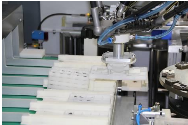
Über das Wechselgreifer-System mit einem zweiten Vakuumgreifer werden die Verpackungsboxen aus der Messzelle an die Endbearbeitung übergeben.
