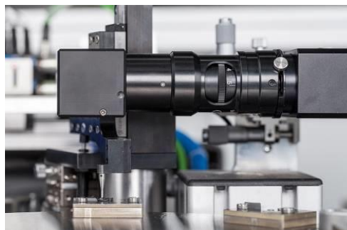
Auf einem Hochgeschwindigkeits-Rundtisch werden die Wendeschneidplatten von CERATIZIT unter das Bildverarbeitungssystem geschwenkt, welches hochpräzise alle Schneidkanten vermisst.
