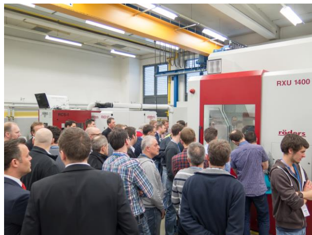
Gut besucht: Workshop-Teilnehmer im Vorführzentrum vor der RXU1400, auf der gerade das Vortex-Demoteil geschruppt wird. Der konstante Ton ist ein Indiz dafür, dass Vorschub und Schnittgeschwindigkeit während der gesamten Bearbeitung stets gleich bleiben (B).
