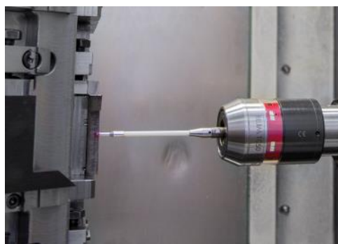
... ist das Resultat vom Einsatz des BLUM-Messtasters TC50.
