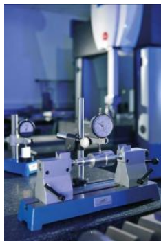
Rundlaufprüfgerät mit Messuhr für Wellen.
