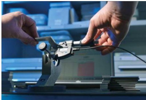
Digitale Bügelmessschraube mit PC-Kopplung.
