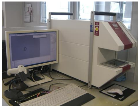
V-CAD 1 mit einem Messbereich von 76 x 63,5 mm kommt in der ‚Scharfschnitt‘-Abteilung zum Einsatz.
