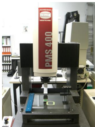
Die in der Qualitätssicherung stehende 3D-Multisensor Portalmeßmaschine PMS wird bei komplexen Messungen eingesetzt.
