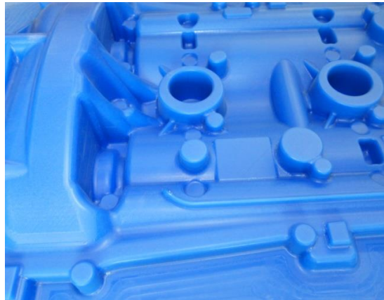
Sammer fertigt zum Großteil für die Automobilindustrie, hier zu sehen ... ist die Kunststoffform einer Zylinderkopfhaube.
