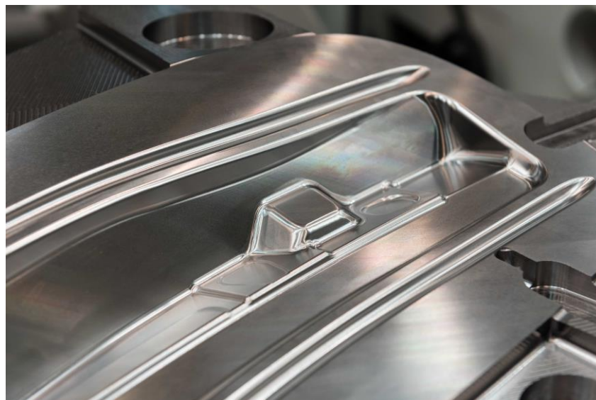
Eine auf dem Workshop mit Beteiligung von MMC Hitachi Tool, FOOKE, Tebis und EschmannStahl fertiggestellte Form einer A-Säule.
