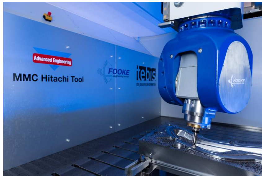
Das Live Fräsen auf einer FOOKE Endura704 Linear mit MMC Hitachi Tool Werkzeugen in 1.2379 weckte großes Interesse.
