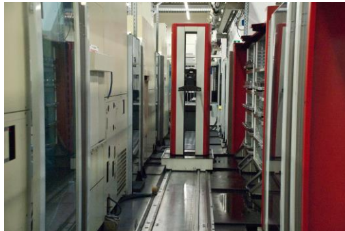
Automatisch und trotzdem flexibel: In der Fertigungszelle von Zimmer+Kreim (Chameleon) sind die Yasda-Maschinen durch einen Linearroboter verkettet, ...
