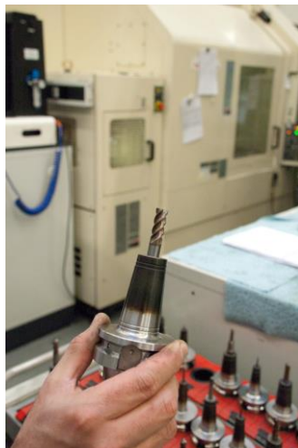
Werkzeugbruch ist Vergangenheit: Werkzeuge, wie dieser Torusfräser der EPP-TH-Reihe gewährleisten beim automatisierten Fräsen einen störungsfreien Prozess.
