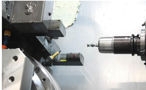
Christmann hat nicht nur BLUM-Messtaster im Einsatz. Das Lasermesssystem LaserControl NT misst Werkzeuge im horizontalen BAZ.
