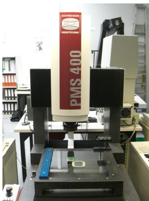
Die in der Qualitätssicherung stehende 3D-Multisensor Portalmessmaschine PMS wird bei komplexen Messungen eingesetzt.
