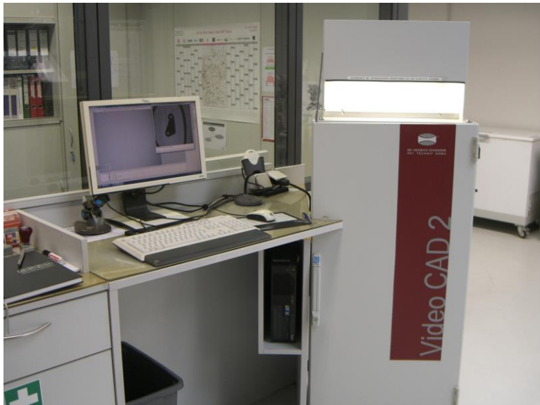
V-CAD 2 mit einem Messbereich von 144 x 108 mm ist zentral in der ‚Scherschnitt‘-Abteilung platziert.
