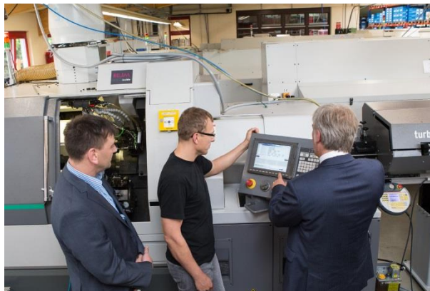
Die Kombination aus dem Messtaster TC76-DIGILOG von Blum-Novotest und der Cincom M32-Drehmaschine brachte den entscheidenden Durchbruch in der Fertigung der Schnellverschlusskupplung.
