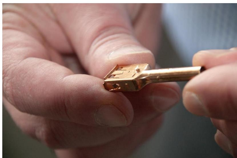
Produziert mit einem einzigen Werkzeug: Diese USB-Buchse wurde von Quittenbaum so optimiert, dass auf ein früher benötigtes Frästeil verzichtet werden kann.
