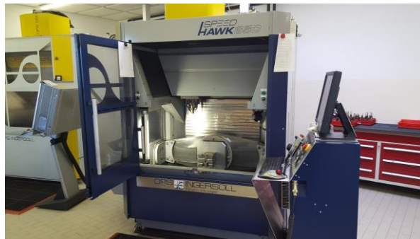
Gewindefräsen, ohne umzuspannen: Hier die 5-achsige OPS Speed Hawk 650 und der auf dem Drehschwenktisch gespannte Formeinsatz. ...
