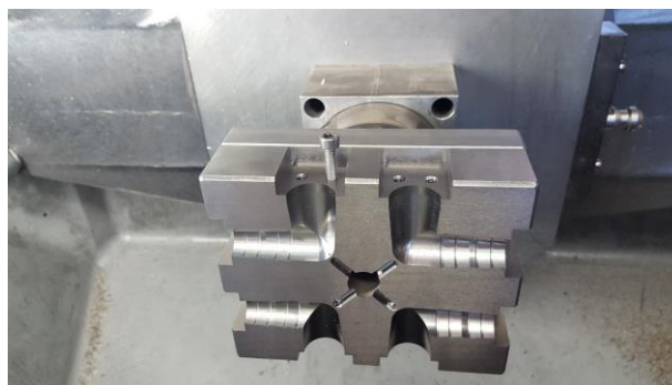
... Auf dieser Maschine war kein Mediumverteiler installiert, weshalb die Druckluft durch die flexiblen Kühlmittelschläuche zugeführt wurde.
