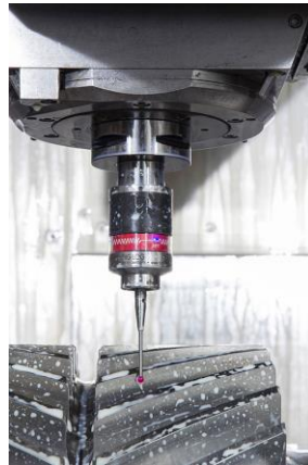
Der Messtaster TC64-DIGILOG scannt jeden Zahn der Antriebswelle auch unter widrigsten Bedingungen.
