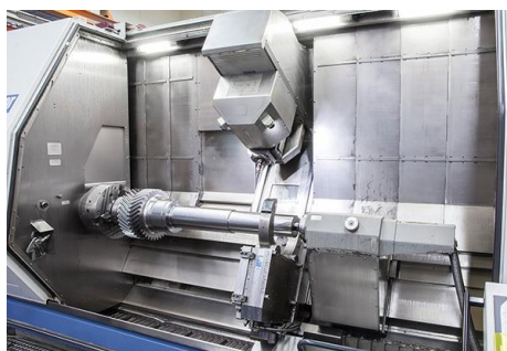
Der Messtaster TC64-DIGILOG scannt die 36 Zähne mit 1,8 m/min und wird im Eilgang positioniert.
