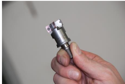
Die tonnenförmige Kontur der Schneidplatte ‚Basic‘ mit Radius R30.
