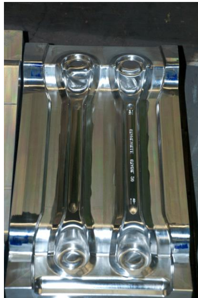
Gefräst in Polierqualität: Fertigbearbeitete Gesenkhälften eines gekröpften Ringschlüssels.
