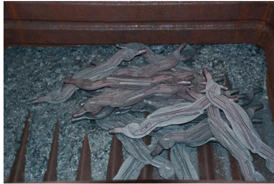
Das geschmiedete Rohteil der Wasserpumpenzange ....
