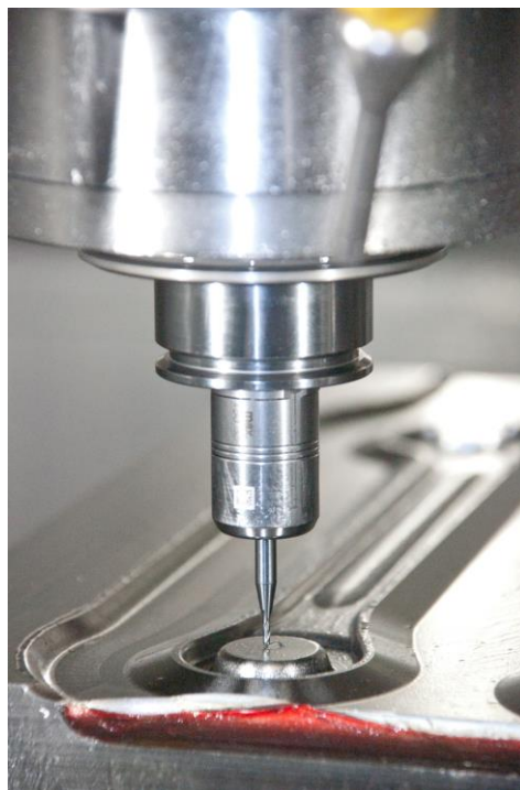
Schwesterwerkzeuge sind weitgehend Vergangenheit: HGOB-Kugelfräser beim Schlichten eines Gesenkkunterteils aus 1.2714 für einen Ringabzschlussel auf der Hermle C 42 V.
