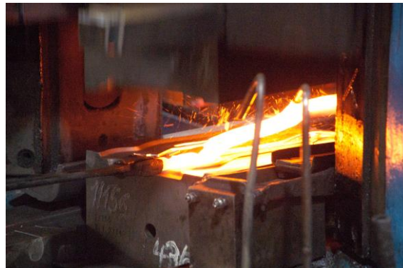
Warmgeschmiedenes Rohlings einer Wasserpumpenzange: Durch Druck zwischen zwei Gesenkhälften ...
