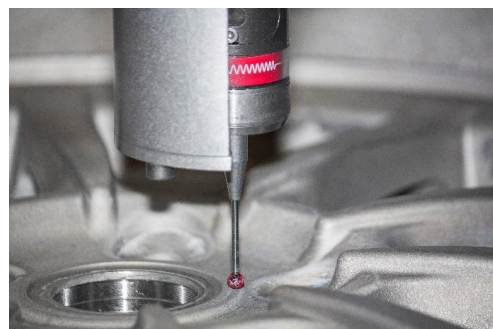
Zum Schutz vor Spänen wurde ein Schutzschild um den Messtaster montiert – dank der zuverlässigen BRC-Funktechnologie wird der Betrieb des Messtasters jedoch nicht gestört.
