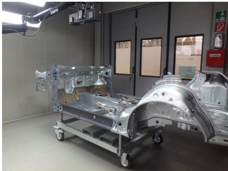
Das System ist mobil und wird dynamisch auf den jeweiligen Montagebereich auf der Karosserie ausgerichtet. Somit können trotz der komplexen Geometrie der Karosserie und den daraus resultierenden Verschattungen alle Bereiche einfach erreicht werden.
