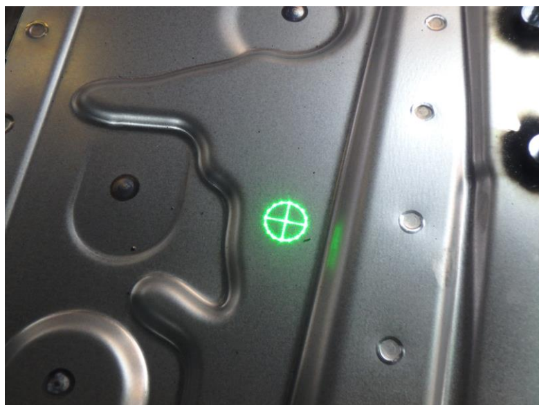
Eine Bolzenposition wird durch den Werklicht Pro Laserprojektor lagerichtig auf das Bauteil projiziert. Sie kann somit einfach angerissen und bebolzt werden. (Bildquelle: Audi/EXTEND3D)
