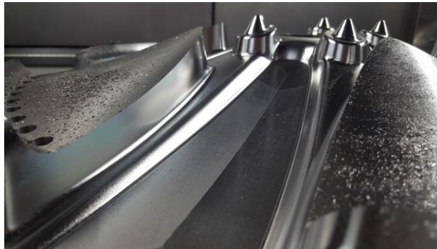
Für das Vorschlichten mit den beiden konischen EPBPN-Kugelfräsern (Durchmesser 4 und 8 mm) ...
