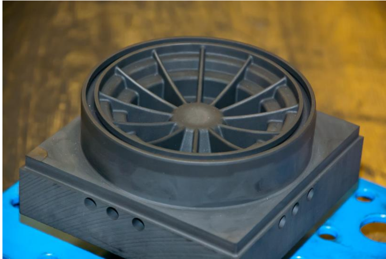
Testobjekt Grafitbearbeitung: Bei dieser Elektrode für die Innenkontur des Gehäuses eines Lüfterdeckels konnte die Fräszeit halbiert werden.
