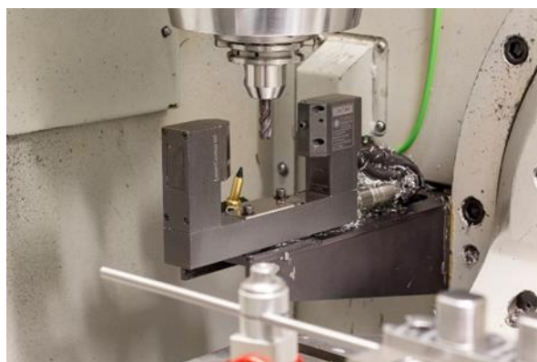
Bei Disterhoft werden alle Werkzeuge im Bearbeitungszentrum mit dem Lasermesssystem Micro Compact NT gemessen, wodurch kein Voreinstellgerät mehr benötigt wird.
