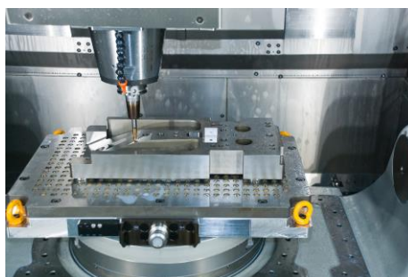
... sowohl geschruppt als auch – zum Teil auf Fertigmaß – geschlichtet wird.
