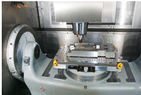
Schwenk- und Drehtisch der automatisierten 5-achsigen Hermle C42 U, auf der ...
