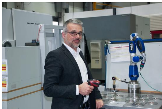
Geschäftsführer Markus Gebhardt am Rüstplatz für Werkstückpaletten. Das Faro-Koordinatenmessgerät dient zur Definition des Nullpunkts, der Handscanner liefert die Barcode-Daten an die Certa-Prozessleitsoftware.
