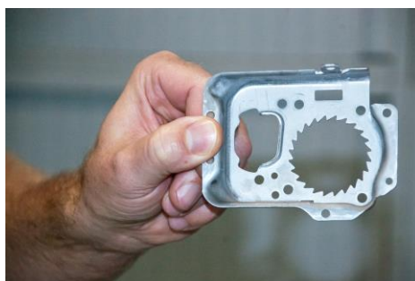
Stanzziehteil, das mit einem Gebhardt-Werkzeug produziert wurde.
