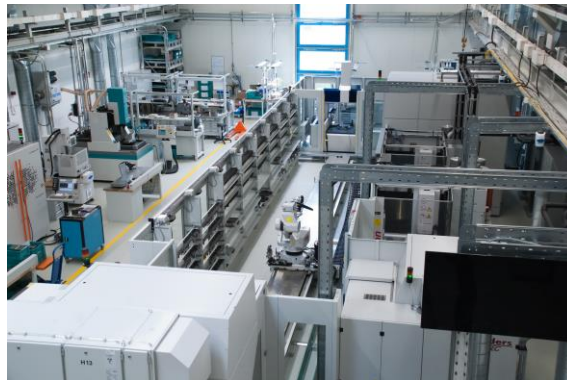
... In der Mitte die Fertigungszelle von Röders für den automatischen 24/7-Betrieb.
