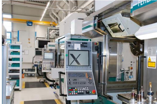
Auf einer der drei Picomax-Maschinen (Fehlmann) fanden die Tests für die Hartbearbeitung von Stahl statt. Gefräst wird hier 3-achsig.
