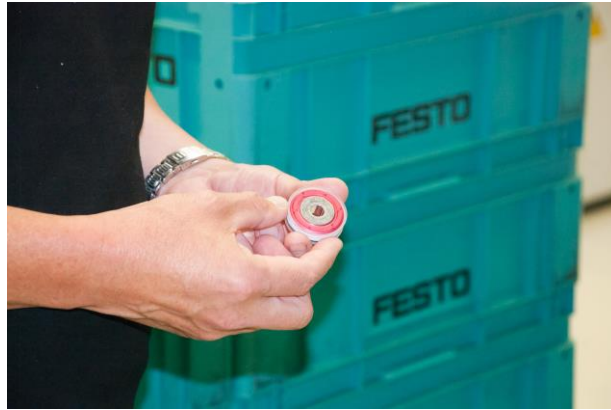
Spritzgussproduktion von 2K-Teilen bei Festo Polymer und der Kolben für einen Pneumatikzylinder. ...
