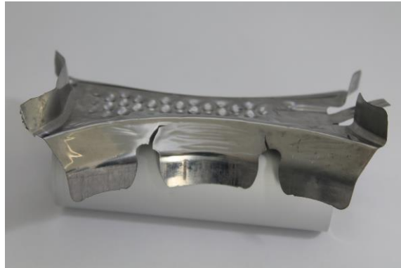
Hitzeschild mit Falten und Risse bestätigt das Simulationsergebnis.
