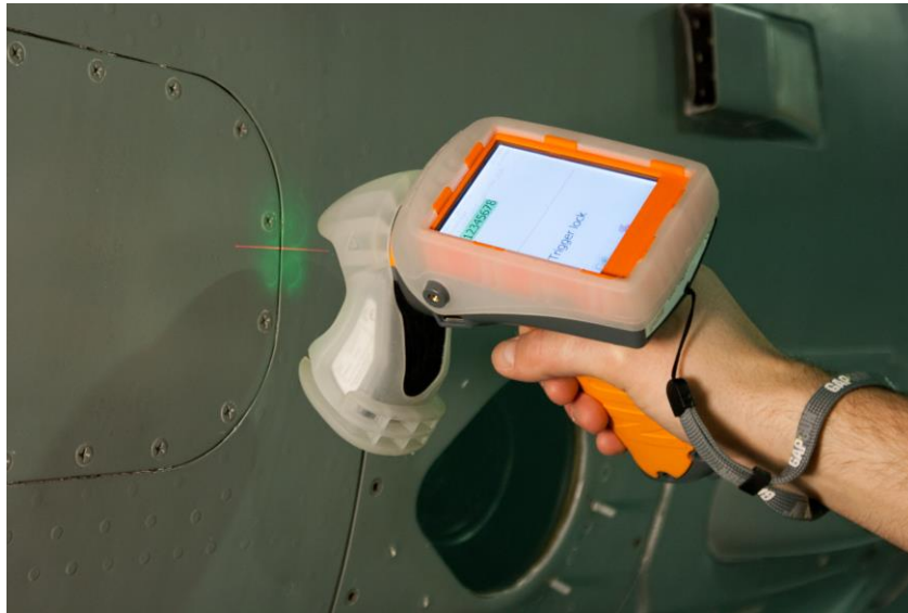
Die GapGun spielt eine wichtige Rolle im Qualitätssicherungsprozess bei Lockheed Martin. (Alle Bilder: Third Dimension)
