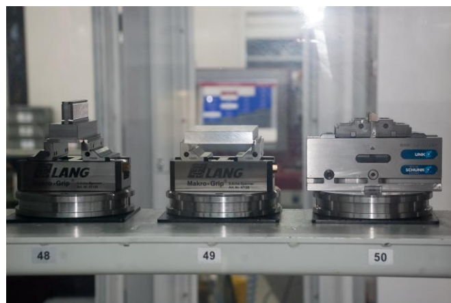
Aufgespannt warten die Werkstücke im Lagerplatz der Anlage auf den Roboter. Unter den Werkstückspannern sorgen Paletten von Erowa dafür, dass der Nullpunkt stets definiert ist.
