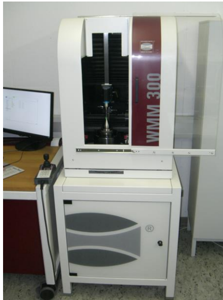
Die WMM 300 ist eine präzise Wellenmessmaschine zur schnellen Messung rotationssymmetrischer Objekte bis 300 mm Länge und maximal 80 mm im Durchmesser.
