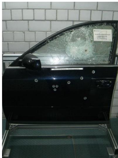
Fahrertür eines sondergeschützten Fahrzeugs, nach dem Beschuss 5b
