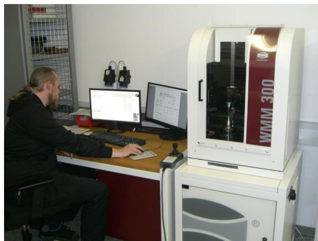
Zum Einsatz kommt die Kombination aus WMM 300 und SAPHIR bei der Vermessung von Lehren, die zur Waffenprüfung genutzt werden.
