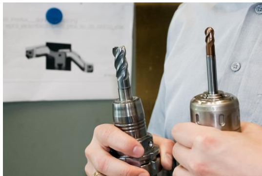
... mit dem EPSM (links) geschruppt und mit dem EHHB-Kugelfräser (rechts) vorgeschlichtet.
