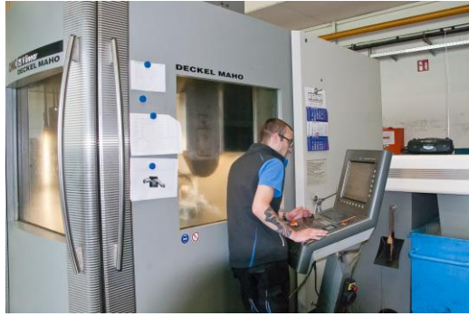
Auf dieser 3-achsigen DMC 75 V linear wurde der Schieber erstmals trochoidal ...
