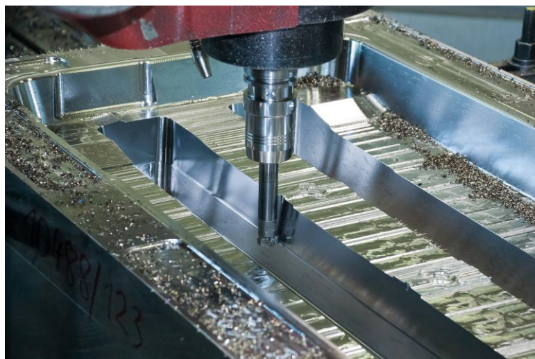
Fräsen im XL-Format: Auf der großen Mecof-Fahrständermaschine sorgt der Wendeplatten-Tonnenfräser ebenfalls für enorme Zeitvorteile. Hier der GF1 beim Abzeilen der Schrägen. (Bilder: MMC Hitachi Tool)
