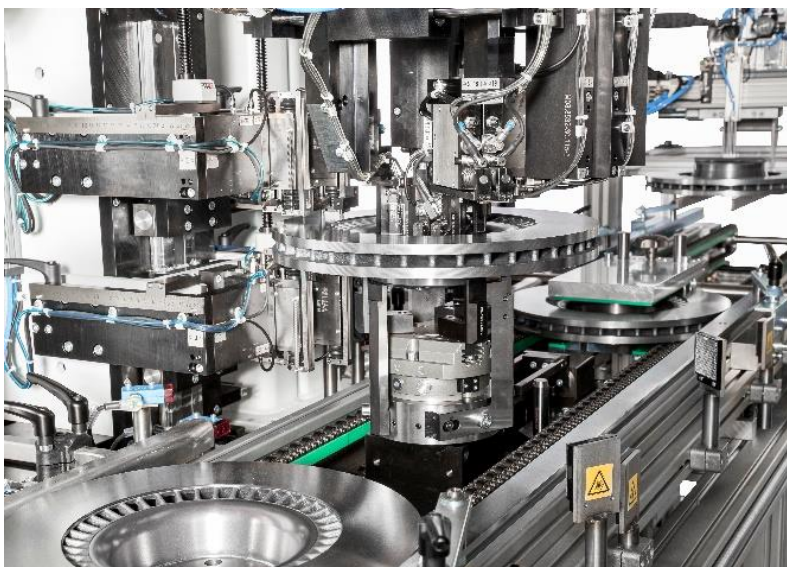
Der Geschäftsbereich entwickelt komplexe Messmaschinen in verketteten Produktionslinien, welche beispielsweise in der Bremsscheibenproduktion eingesetzt werden. (Bilder: Blum-Novotest)
