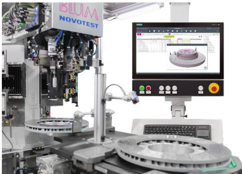
Die neue Mess- und Auswertesoftware M4P wurde speziell für die Post-Prozess-Messanlagen von Blum-Novotest entwickelt.
