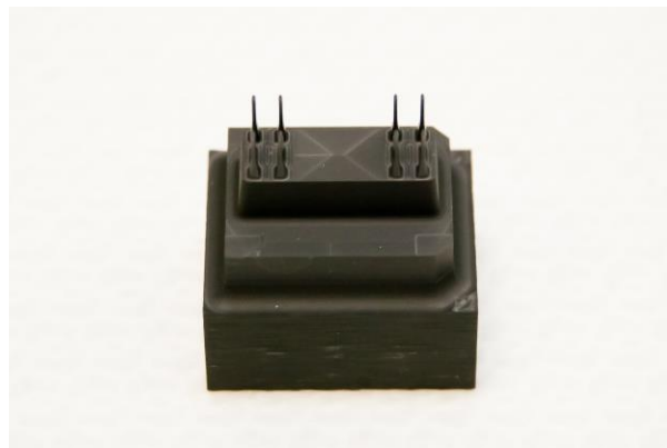
Typische Grafitelektroden, die auf den Exeron-Maschinen gefräst wurden. Die Toleranzvorgabe ist +/- 0,005 mm.
