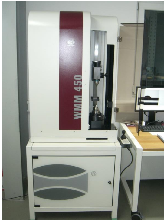
Die WMM 450 steht in der Produktion von HIPP Medical und dokumentiert fertigungsbegleitend die Präzision bei rotationssymmetrischen Drehteilen aus Titan. (Bilder: Schneider Messtechnik)
